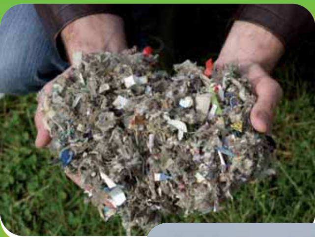
So sieht der fertige Brennstoff aus, der aus Abfällen hergestellt wird
