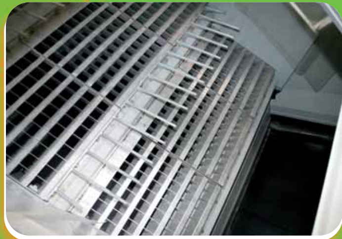
Siebe, wir sagen Schwingsiebe, trennen die großen von den kleinen Abfallstücken. Die großen Stücke werden anschließend zerkleinert
