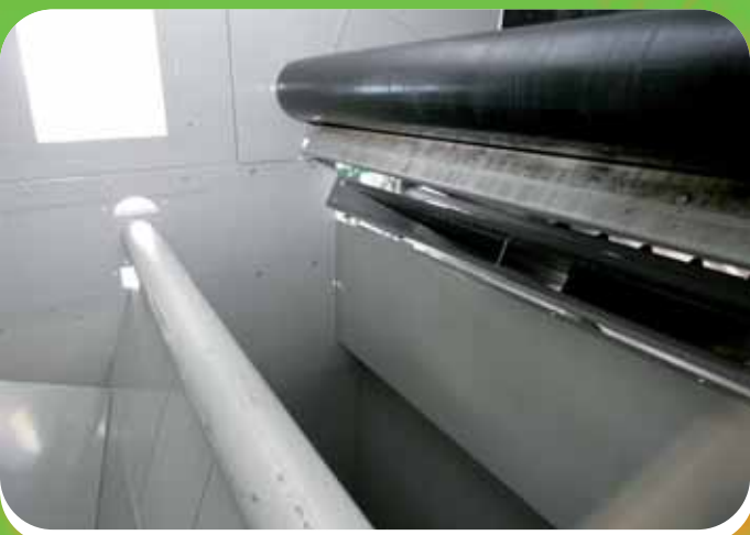
Diese Maschine arbeitet wie ein großer Fön und bläst leichte Stücke, z.B. Papier oder Kunststoffe, aus dem Abfall hinaus
