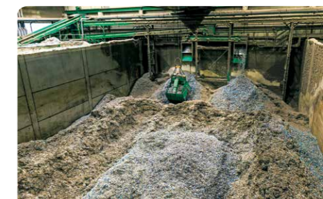
Der erzeugte Ersatzbrennstoff lagert in Ennigerloh, bevor er zu Zement- und Kraftwerken geliefert wird. Dort ersetzt er pro Jahr rund 25.000 Tonnen Braunkohle.
