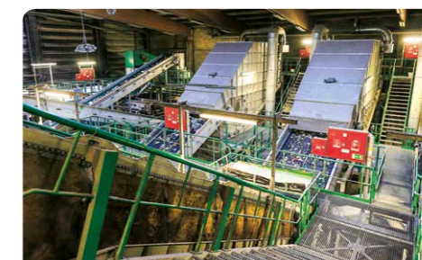
Stoffspezifische Abfallbehandlung bedeutet auch immer eine technisch hochwertige, maschinelle Sortierung der Abfälle, wie hier in der Mechanischen Abfallbehandlungsanlage in Ennigerloh.
