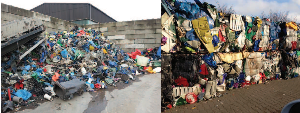
Abbildung 24: Zur Transportoptimierung werden Kunststoffhohlkörper am Umschlagplatz zerkleinert oder balliert
